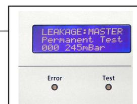
Während des PERMANENT TEST wird der Druck im Endoskop solange aufrecht erhalten bis die Undichtigkeit visuell festgestellt wurde oder die Stop-Taste ③ betätigt wurde.
