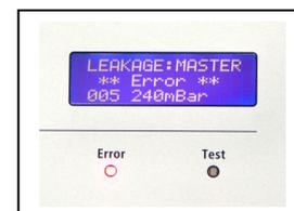
**Überprüfen Sie das Endoskop oder Anschluss und Dichtigkeit des Anschlussschlauchadapters.**
