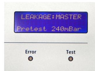
Im Gegensatz zu den Bedienungsanleitungen der Endoskophersteller erfolgt der Pre-Test in bewegungslosen, möglichst gestreckten Zustand. Der Pre-Test erkennt auf dieser Weise bereits Mikroperforationen.
